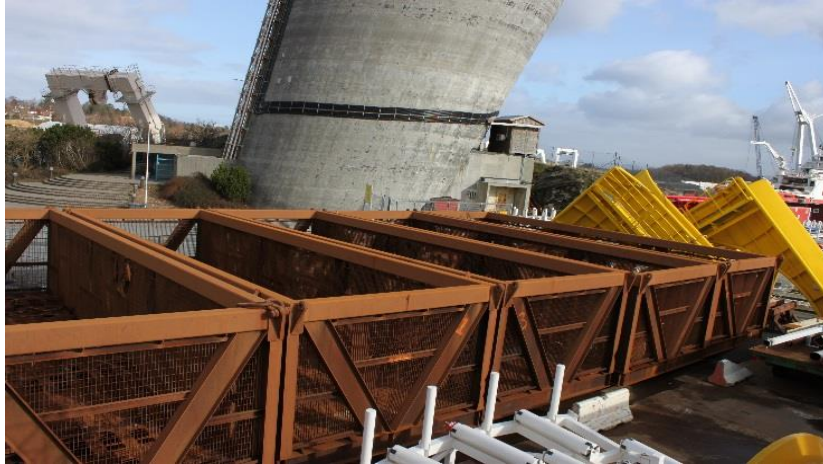
Subsea baskets 11,5 x 4,1 x 3 m (LxWxH). Payload 36 ton
