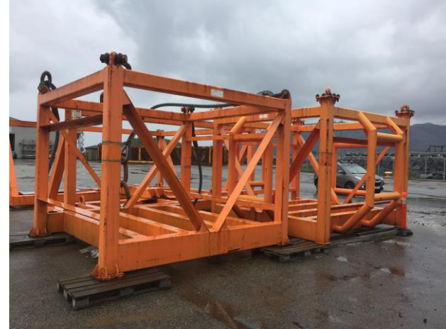
Subsea baskets 3,6 x 3,7 x 3 m (LxWxH). Payload 175 ton
